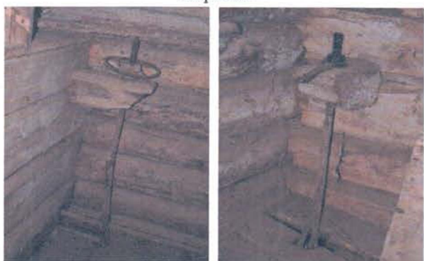
Механизмы регулировки камней (меняет размер помола)
