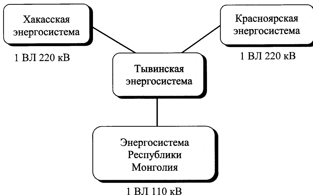
Рисунок 6.4.1 – Структурная схема внешних электрических связей Тывинской ЭС
