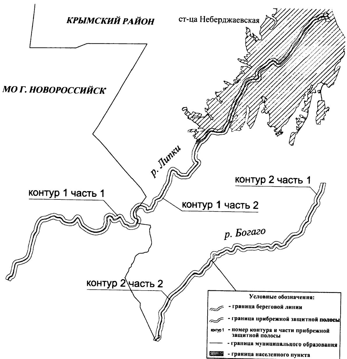
2. Границы водоохранной зоны и прибрежной защитной полосы, местоположения береговой линии (границы водного объекта) водного объекта – реки Липки:
