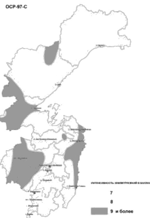
На площадках строительства, где не проводилось сейсмическое микрорайонирование, в виде исключения допускается определять сейсмичность согласно картам ОСР-97 для территории края, кроме случаев проектирования особо опасных, технически сложных и уникальных объектов, а также проектирования социально значимых зданий и сооружений (школ, больниц, спор-
