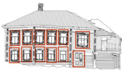
Накладной наличник трехчастного оконного проема (северный фасад второй этаж)
