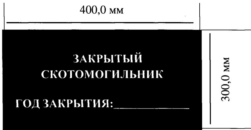
Табличка изготавливается из металла толщиной не менее 1,0 мм и крепится к металлической либо пластиковой опоре диаметром не менее 25,0 мм. Табличка устанавливается на верхней точке кургана горизонтально. Расстояние от нижнего края таблички до верхней точки кургана должно составлять не более 300,0 мм. Табличка имеет черный фон, на который наносится надпись белого цвета, несмываемой водой краской. Надпись должна занимать не более 3/4 площади таблички.
