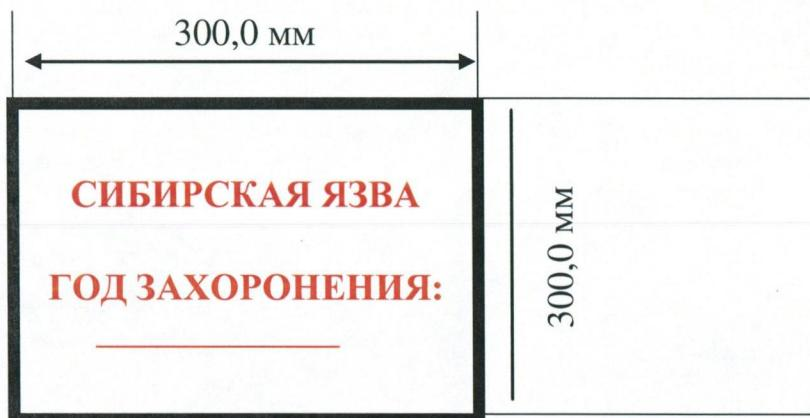
Табличка изготавливается из металла толщиной не менее 1,0 мм и крепится к металлической опоре диаметром не менее 15,0 мм. Табличка устанавливается на верхней точке бетонного купола. Расстояние от нижнего края таблички до верхней точки бетонного купола должно составлять не более 300,0 мм. Табличка имеет белый фон, на который наносится надпись красного цвета, несмываемой водой краской. Надпись должна занимать не более 3/4 площади таблички.
