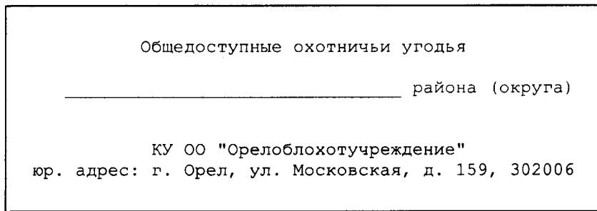
Информационный знак имеет прямоугольную форму размером не менее 40 x 60 см, изготавливается из листового металла (например, оцинкованной жести) и крепится к верхней части основания (столба) на расстоянии 180 см от поверхности земли.
