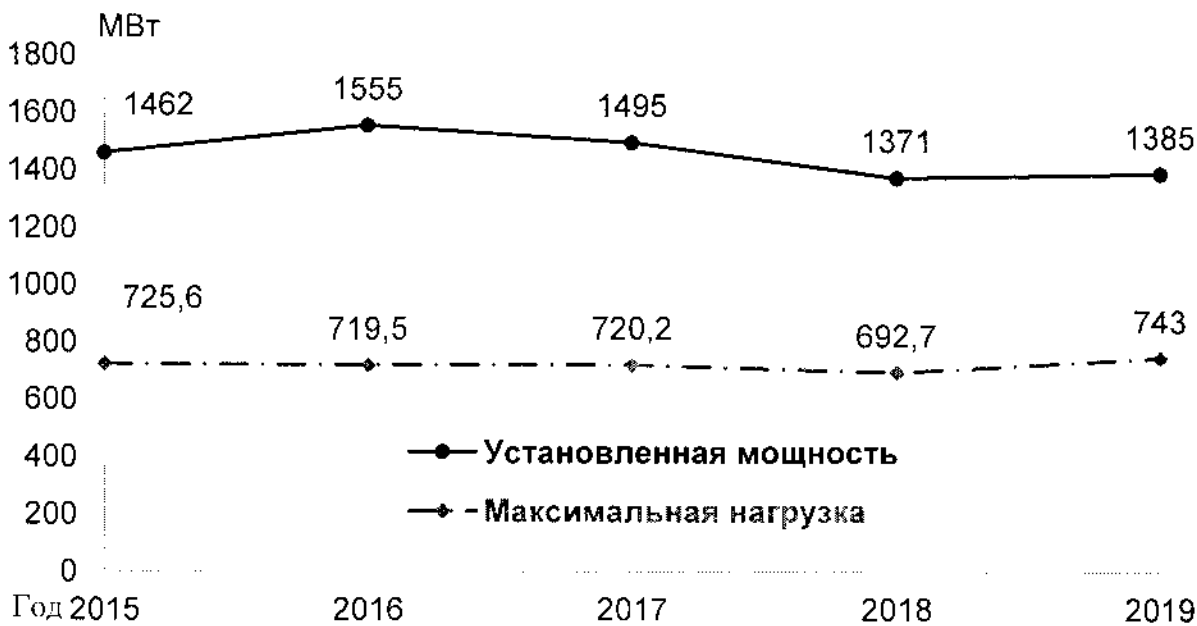
Схема 12. Баланс электрической мощности ЭЭС ЯНАО за период 2015 – 2019 годов
